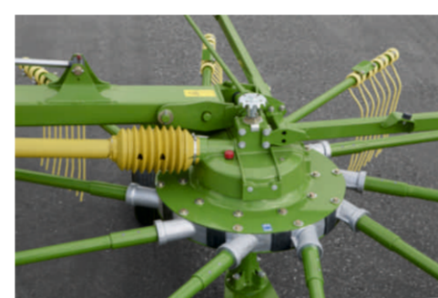
Рис. 2. Закрытый конический зубчатый редуктор, не требующий обслуживания благодаря непрерывной смазке
