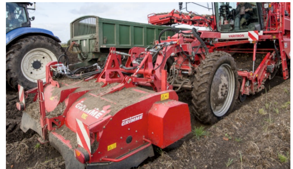
2-рядный, 354 л.с., перегрузочный бункер объемом 2 т, высокая эффективность сепарации, гусеничный ходовой механизм
