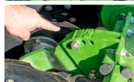
Рабочая глубина дисков изменяется гидравлически из кабины и имеет хорошо видимую шкалу. Высота четырех наружных дисков устанавливается отдельно с помощью болта и отверстия
